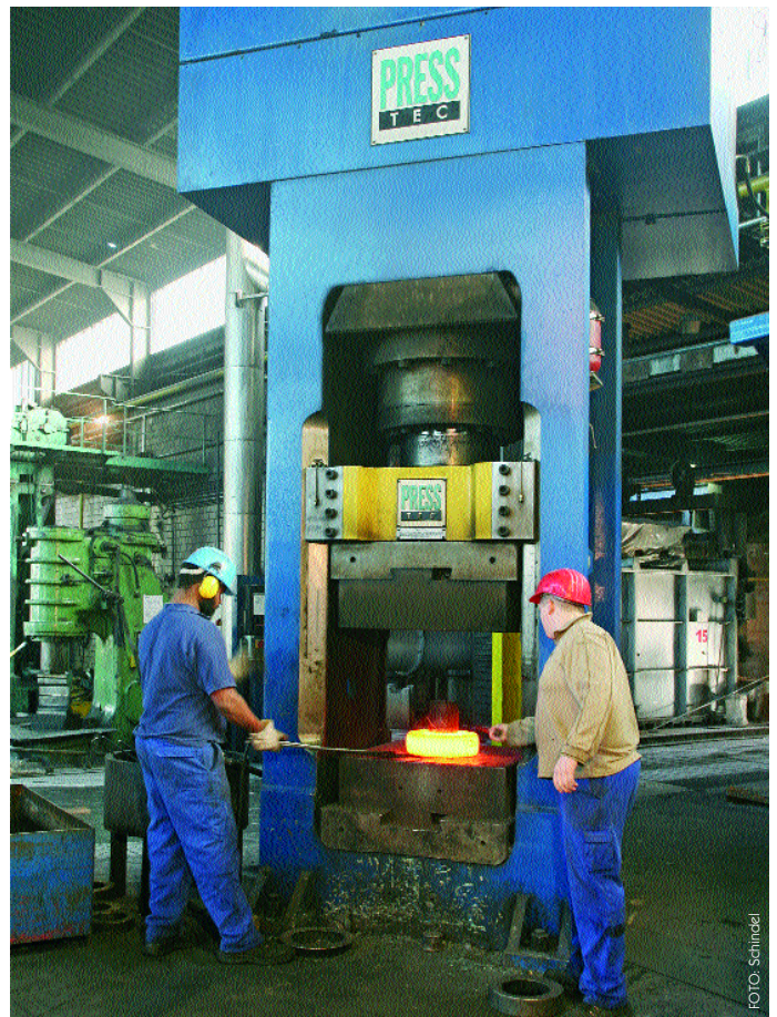
Fortschritt bei der Fertigung von Ringrohlingen: die neue Kompaktpresse.
