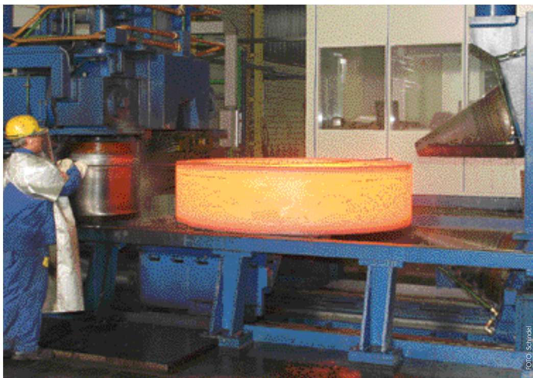
Mit dem weltweit modernsten Ringwalzwerk fertigt Edelstahl Rosswag nahtlos gewalzte Ringe mit bis zu 3.000 Millimetern Außendurchmesser und 630 Millimetern Höhe.
