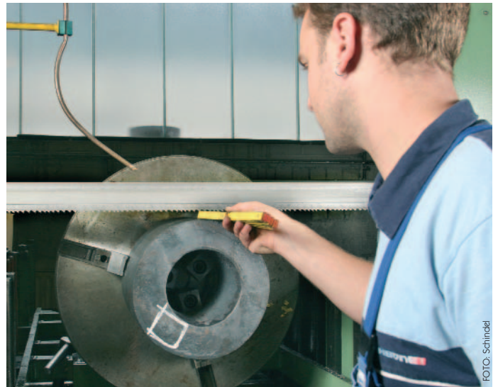
Stimmt der Abstand? Ein Mitarbeiter überprüft die Position des Werkstücks in der neuen Ringsäge.
