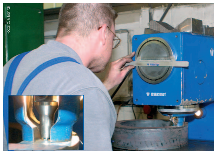
Bei der Härteprüfung wird eine Stahlkugel in die Materialoberfläche eingedrückt
