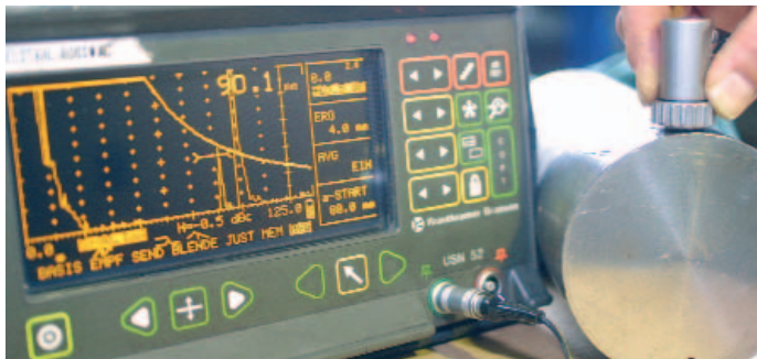
Setzt Erfahrung und Fingerspitzengefühl voraus: Prüfung mit Ultraschall
