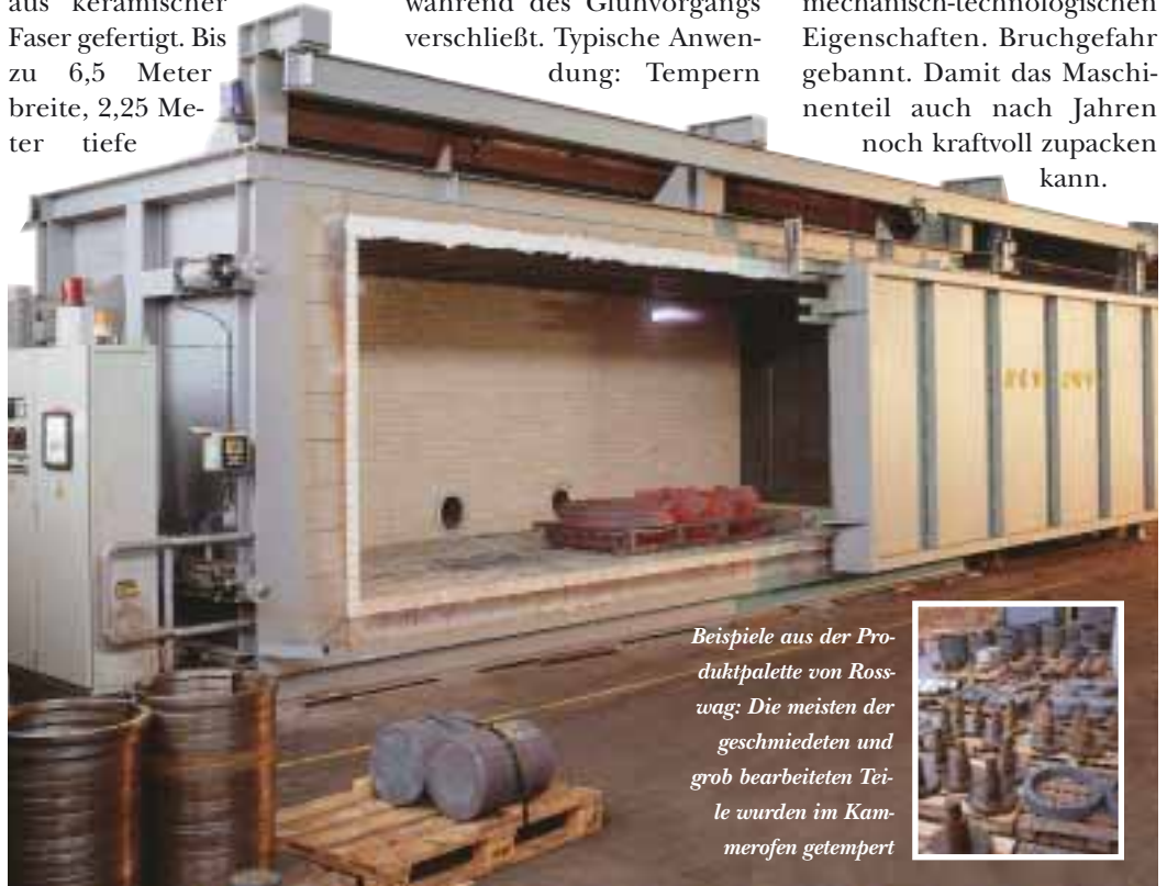
Der neue, rund 9 Meter breite Kammerofen: Unterhalb der Decke zischt die blaue Erdgasflamme aus der Wand. Fotos: Dirbach
